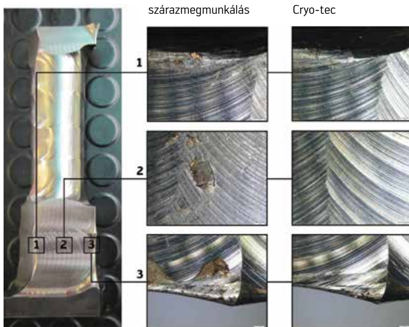
Lapáttó nagyolómegmunkálásának összehasonlítása száraz eljárás, illetve CO 2 -t használó hűtési folyamat esetén
